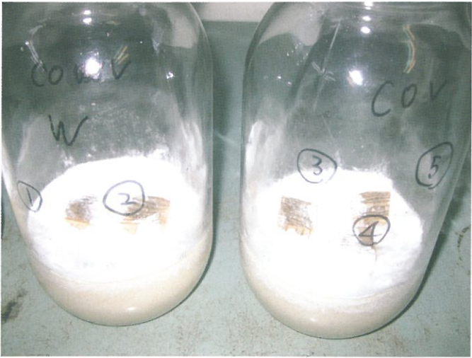
JIS K 1571 (2010) オオウズラタケ室内実験 カワラタケ室内実験
